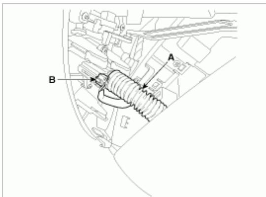
9. 拧下固定螺钉，拆卸空调&暖风控制模块(A)。
