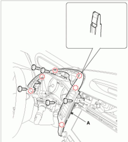
4. 拧下固定螺钉后，分离连接器(A)，拆卸中央装饰板(B)。
