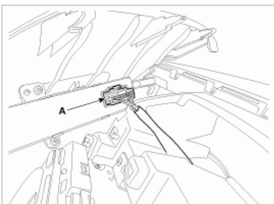
6. 拧下固定螺钉，拆卸中央通风口总成[右](A)。
