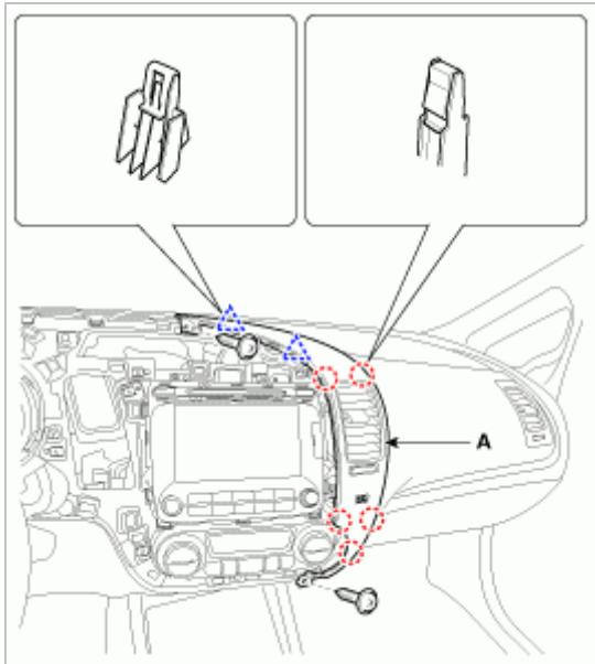
7. 拆卸室内温度传感器软管(A)。
